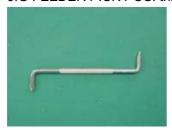
■ Torque screwdriver(KJ3-MJ151-00, TORQUE DRIVER)
